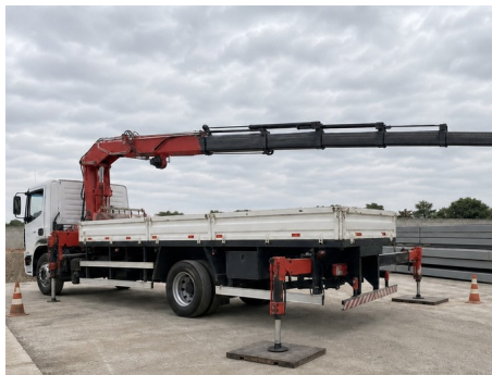
Foto - Patolamento lado esquerdo
