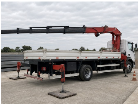
Foto - Patolamento lado direito
